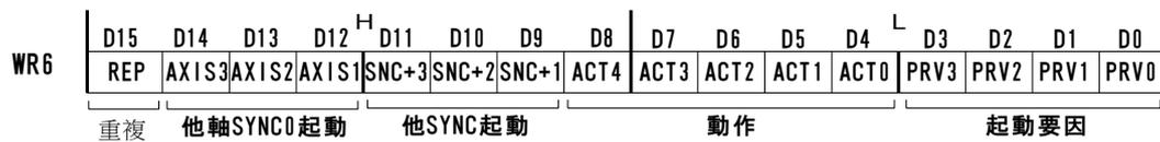
D3~0 PRV3~0 同步動作的起動要因編碼指定。
